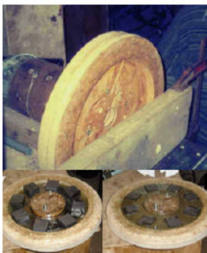
Rotore in costruzione e in uso
