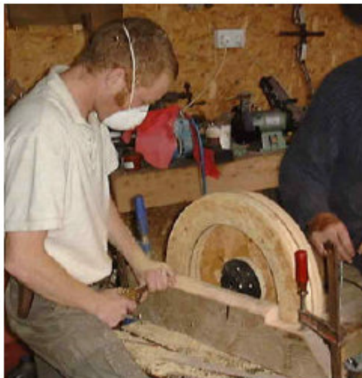
Tornitura di stampo per statore su un motore elettrico
