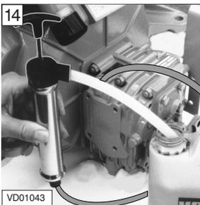
Arrestare il motore e sostituire l'olio del cambio direzionale (pag. 33).
