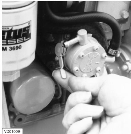
Una seconda valvola di sfiato si trova sulla pompa del combustibile.
