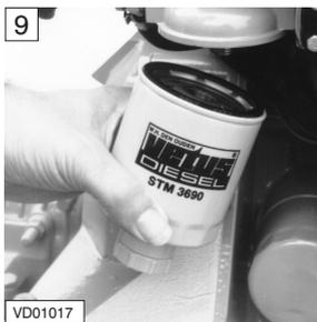
9 Montare un nuovo elemento filtrante per il combustibile (pag. 36).
