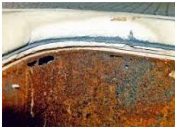
fig.2d : Corrosione di una lastra di ferro metallico in atmosfera.
