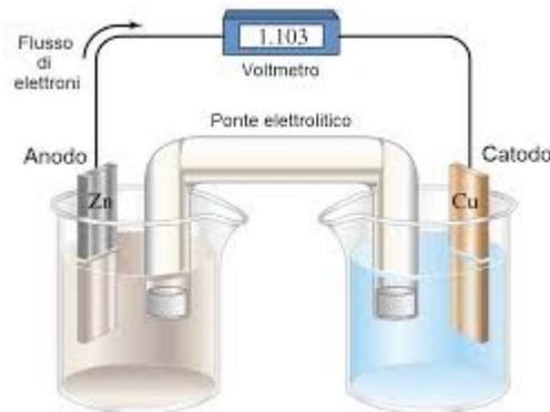
fig.1c : Schema della "pila Daniell"
