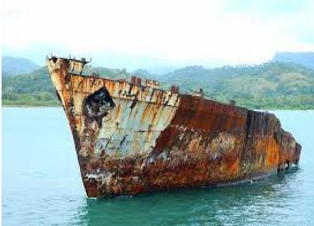
fig.3a : Corrosione di di uno scafo navale in ambiente.
