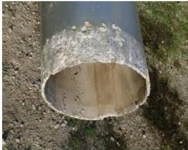
fig.2g : Corrosione di un tubo in acciaio.
