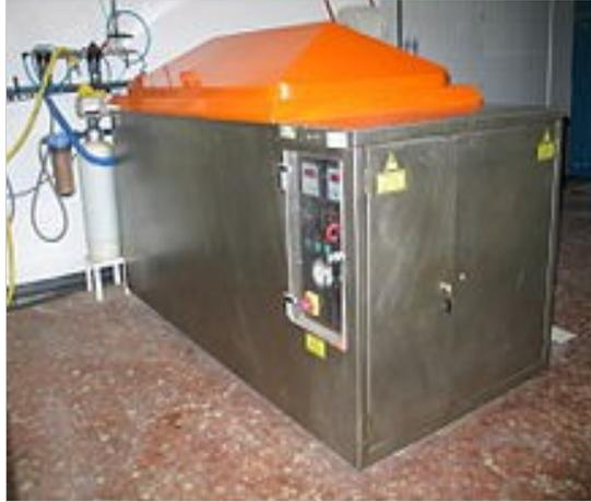
fig.5a : Camera di corrosione.
