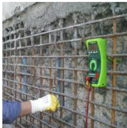
fig.5i : Misura della resistenza di armatura.
