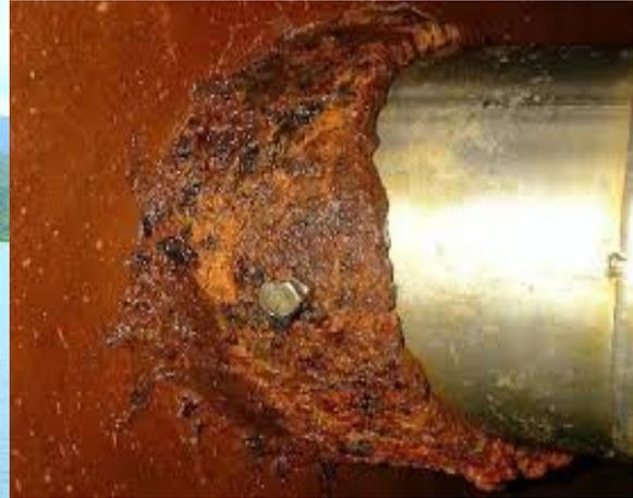
fig.3 :b Corrosione galvanica di una tubazione.
