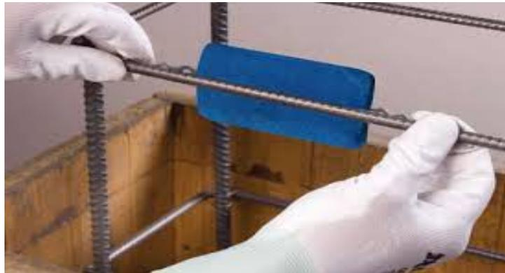
fig.4y : Anodo galvanico in zinco applicato ai tondini dell'armatura del calcestruzzo.
