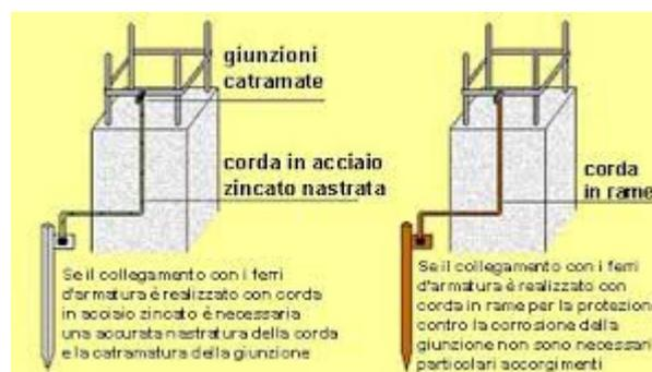
fig.4x : Tipologie di collegamento tra dispersore e tondini dell'armatura.
