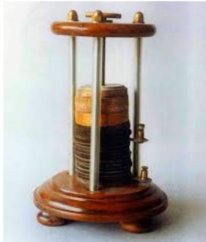
fig.1b : La "pila Volta".
