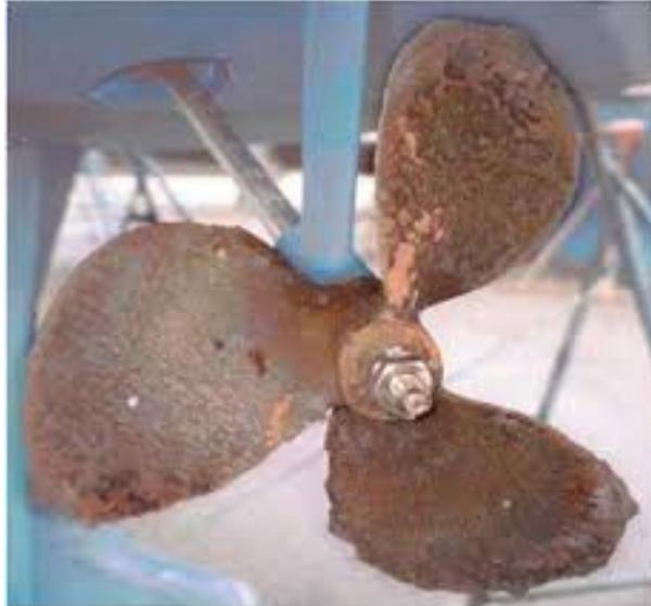
fig.3f: Corrosione di un elica in ferro con albero motore in acciaio inox.
