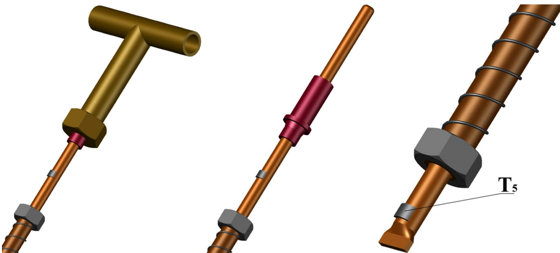
Fig. 3.5: spaccato dell'accoppiamento heat pipe.collettore
