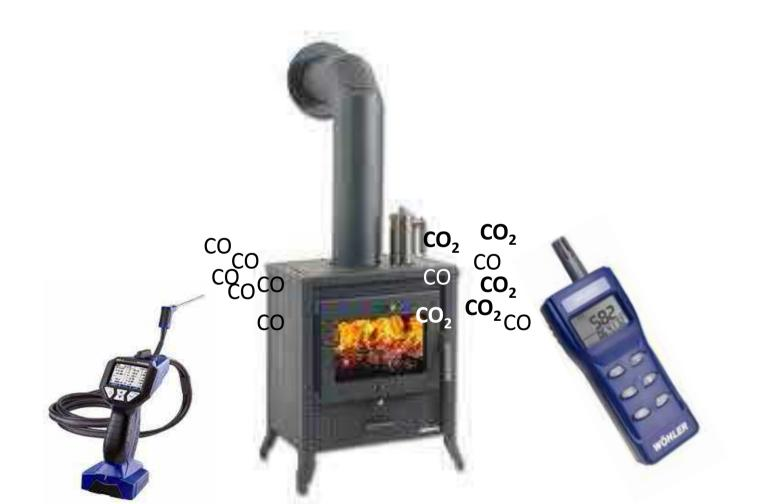
Nel caso di anomalie si deve fare il test 4 Pa e la misura del tiraggio
