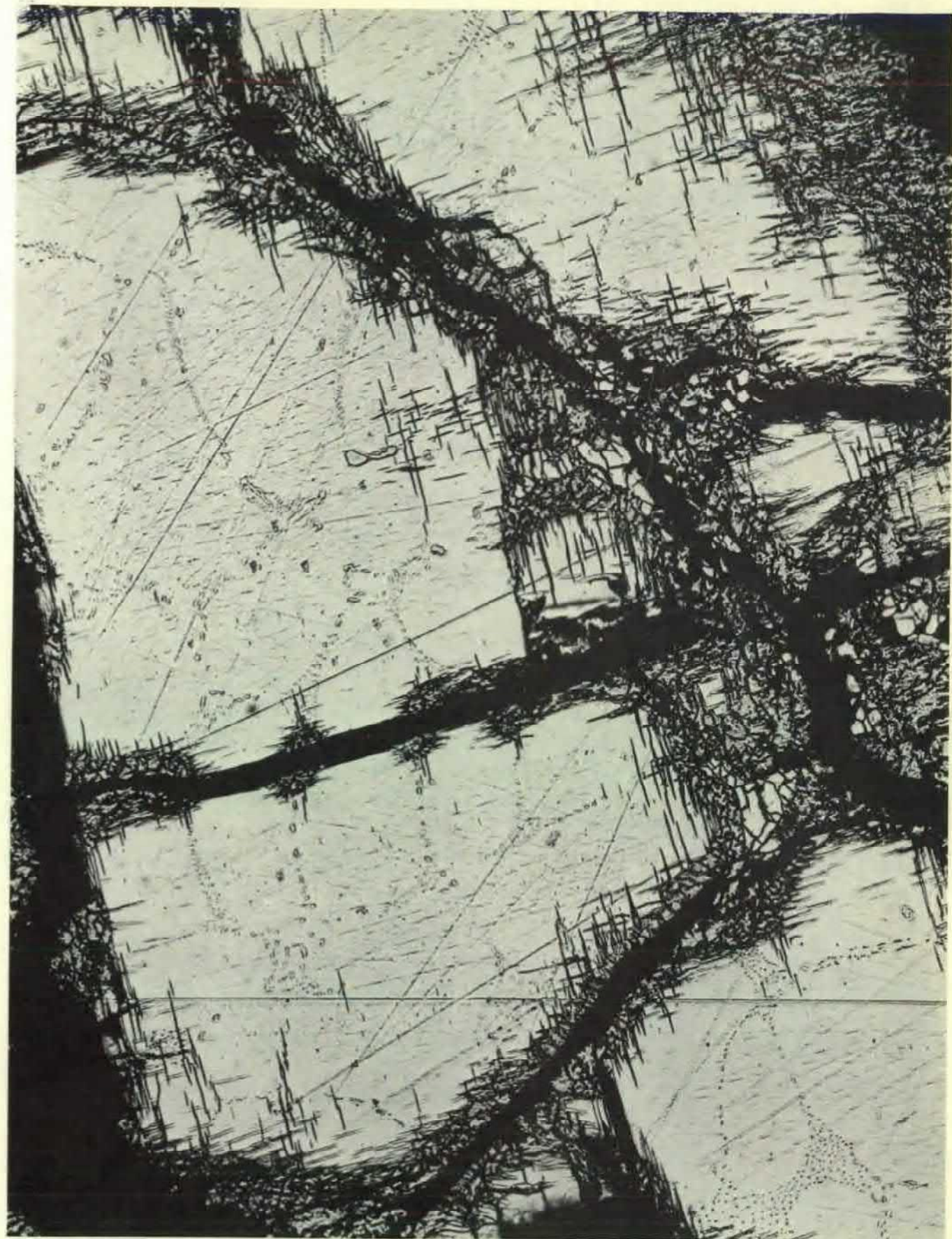
In questa sezione metallografica preparata da uno degli autori (Sandrock) presso l'Inco Research and Development Center sono visibili frammenti parzialmente idrurati di una lega di ferro-titanio a un ingrandimento di circa 400 diametri. Le aree molto ricche di fenditure nei pressi della superficie delle particelle sono già in larga misura idrurate. Poiché la densità dell'idruro è minore di quella della lega metallica, le
