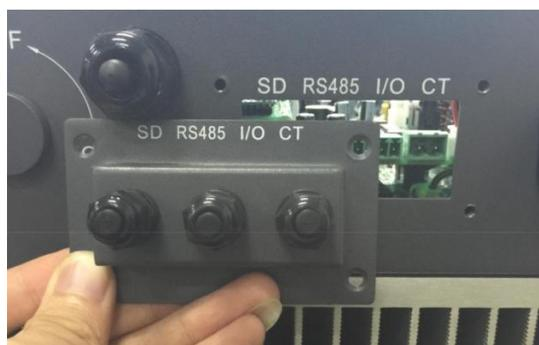
3. Inserire l'altro capo del cavo di rete attraverso il pressacavo e il coperchio come mostrato in figura.
