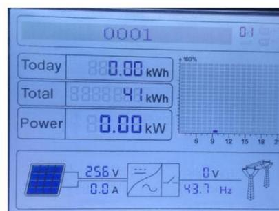
Premere ancora enter per abilitare la funzione di Reflux Power ed inserire, tramite i tasti up e down, il valore di potenza che si desidera immettere in rete, confermando infine col tasto enter. A questo punto comparirà sul display la scritta "Success" se la procedura sarà andata a buon fine e sarà possibile tornare alla schermata principale del display dell'inverter.
