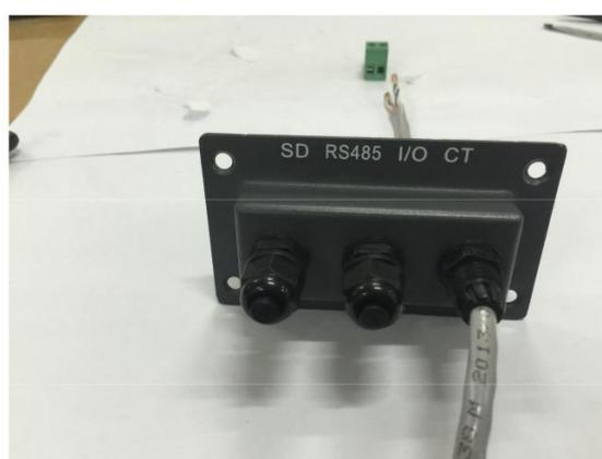
4. Collegare il cavo di rete e il morsetto CT, assicurare il collegamento usando un cacciavite a punta piatta.
